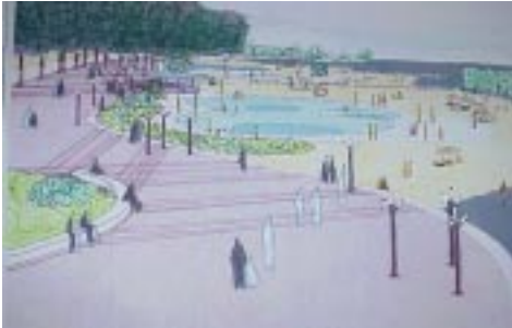
Il lungolago sarà largo 10 metri oltre a 7 metri di fascia verde. Queste dimensioni verranno realizzate tramite immissione di materiale lungo la costa. Attualmente la passeggiata a lago è larga circa 2,50 metri
